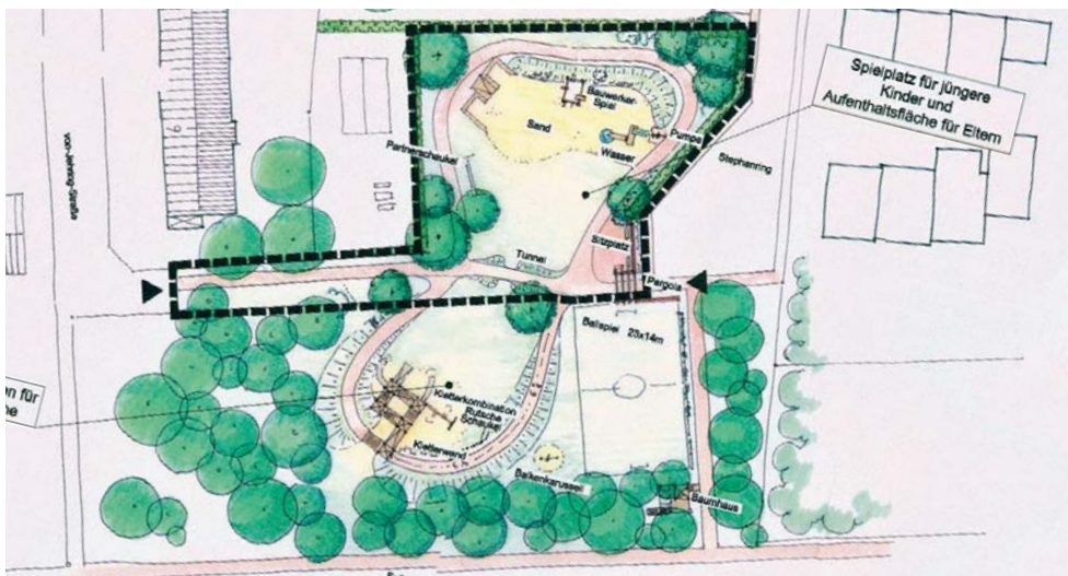
Nasse Füße werden demnächst auf dem Spielplatz am Stephanring der Vergangenheit angehören. Im Zuge der Bauarbeiten wird ein Drainagesystem zur Entwässerung des Platzes verlegt. Ein befestigtes Wegenetz sorgt außerdem für Trittsicherheit.
